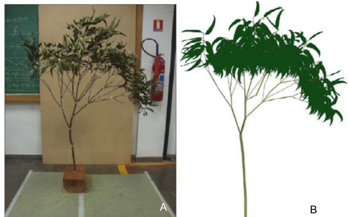
(A) Galho de eucalipto ensaiado no túnel de vento; (B) Galho digitalizado.
