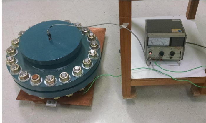
Isolação elétrica em Flange
