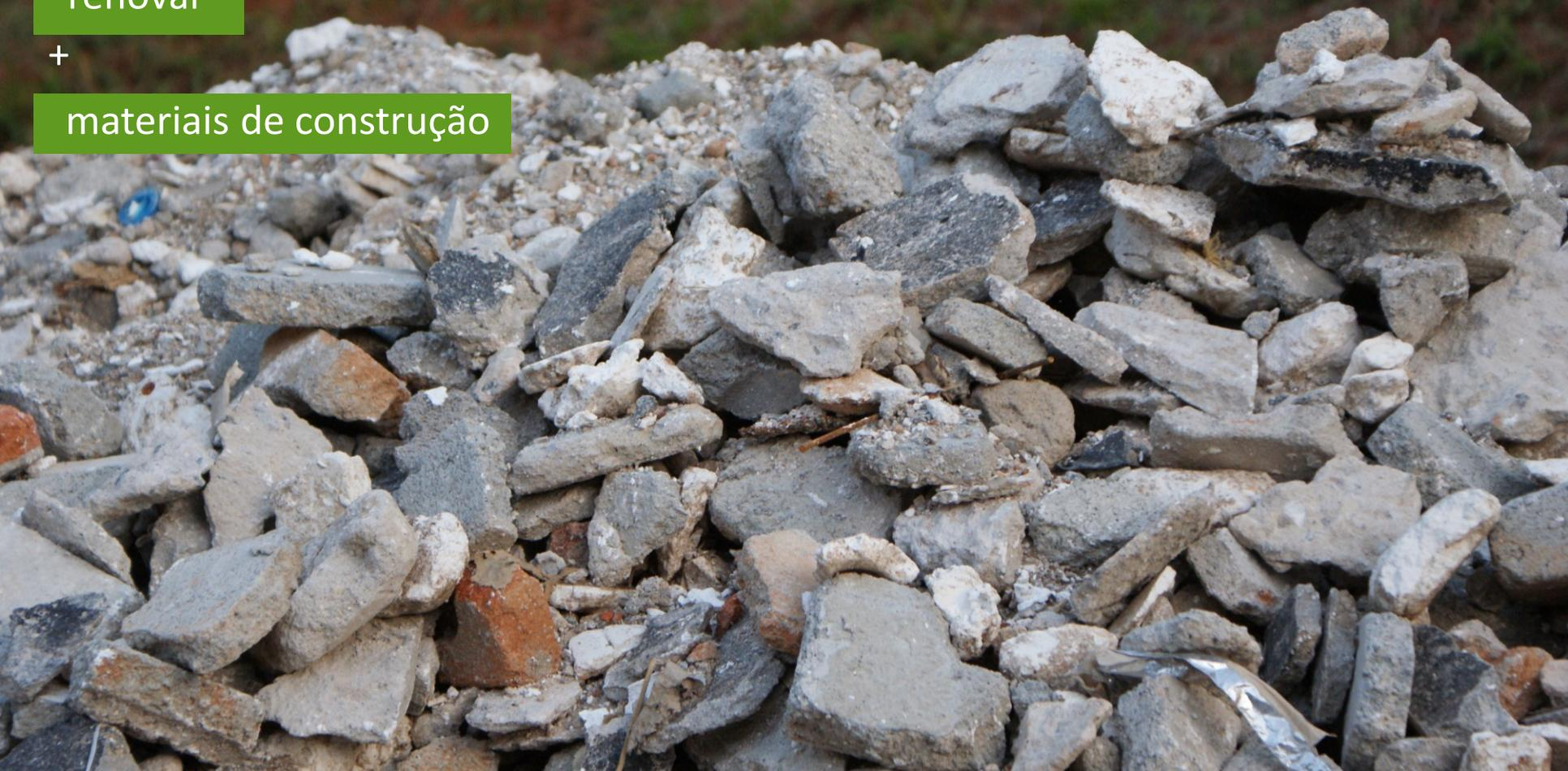
Com recursos do BNDES, o IPT desenvolveu para a InterCement um cimento feito a partir de **Resíduos de Construção e Demolição (RCD)**. Além de diminuir o envio dos RCDs para aterros, o material terá custo reduzido e baixo impacto ambiental.
