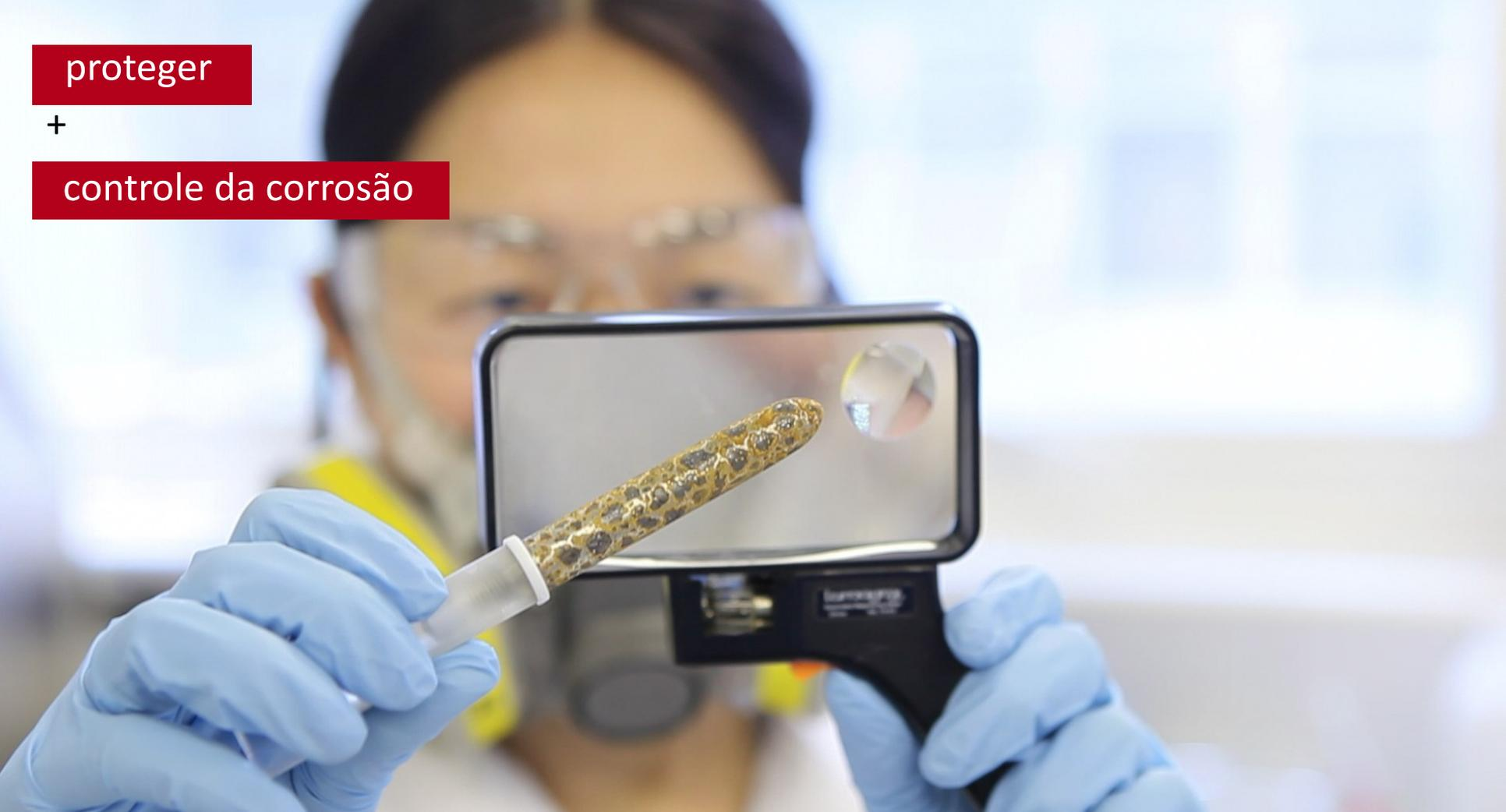
A pedido da Petrobras, o IPT verificou a eficácia do ensaio NACE TM0172 e propôs **melhorias na metodologia**. Revisado, o ensaio é usado internacionalmente para avaliar, e assim, controlar a corrosão interna em dutos de petróleo e derivados.
