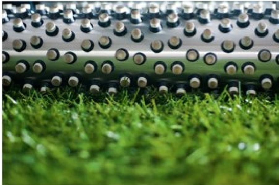
Equipamento Lisport – Ensaio de desgaste acelerado em gramados sintéticos
