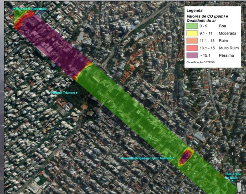
Baseado na **Internet das Coisas (IoT)**, um projeto do IPT mapeia a qualidade do ar na Avenida Paulista por meio de sensores móveis instalados em veículos, que enviam dados em tempo real e ampliam a cobertura do mapeamento já existente.
