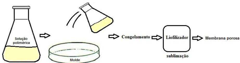
Ilustração esquemática do processo de obtenção de *scaffolds* por liofilização
