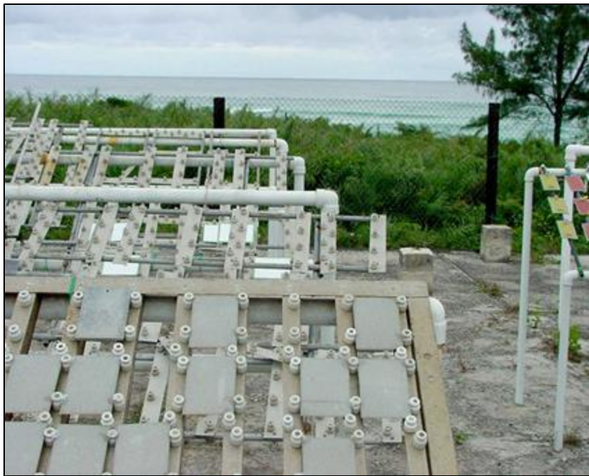
Painel de corrosão atmosférica insalada em Restinga do Marambaia - RJ
