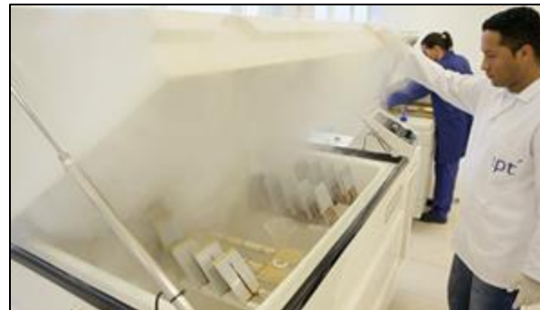
Qualidade da passivação (compara-se com aço AISI 321)
