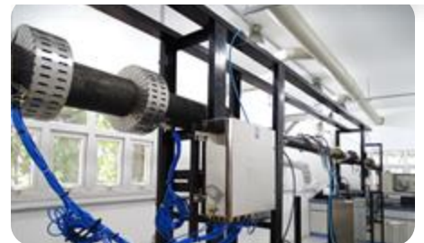
Loops de corrosão
