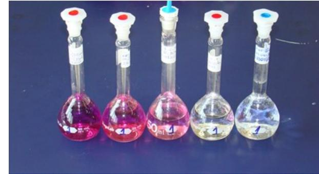
Espectrometria UV-Visível para permanganato de potássio (acima) e persulfato de sódio (abaixo).
