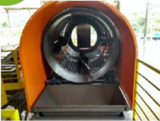
Trommel: Peneirador rotativo para recuperação de matéria orgânica
