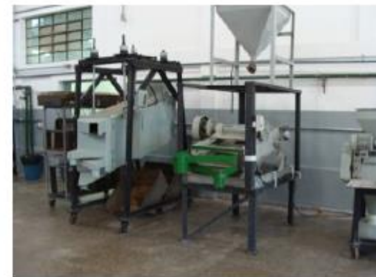
Análise granulométrica: cominuição e classificação
