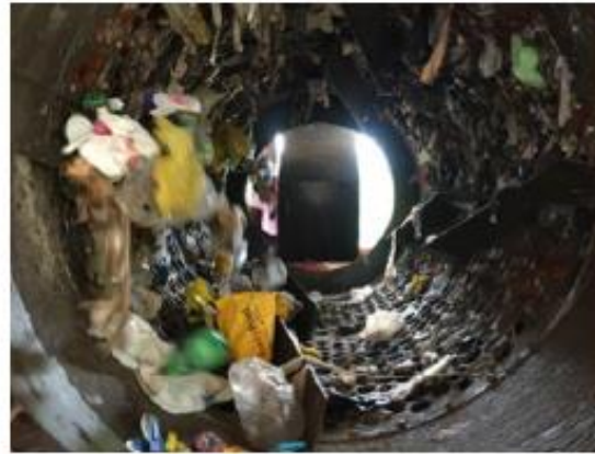
Trommel: Peneirador rotativo para recuperação de matéria orgânica
