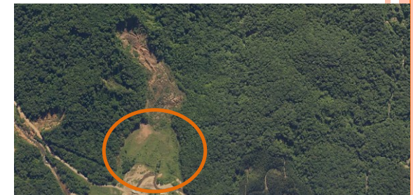
Figura 28 - Depósito de acumulação em sopé de encosta, com indicação de suscetibilidade a movimentos gravitacionais de massa - Ilhota, SC.
