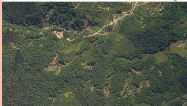
Figura 24 - Cicatrizes de deslizamentos recentes, visualizadas em escala 1:12.500 - Ilhota, SC.
