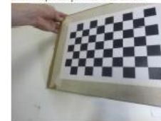
Figura 2 - Padrão quadriculado utilizado para a determinação dos parâmetros da câmera.
