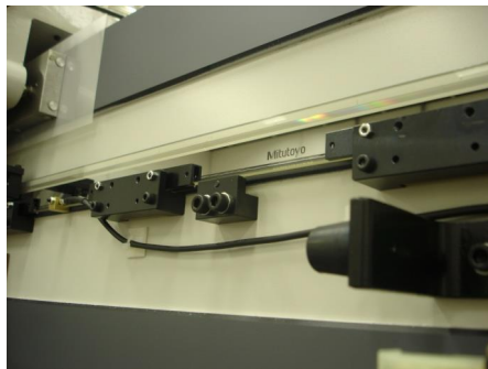
Fixação das escalas
