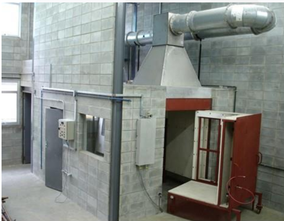
Figura 10 – Ensaio SBI – Single Burning Item de acordo com a EN 13823 (Fonte: IPT)
