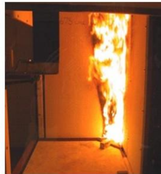
Figura 10 – Ensaio SBI – Single Burning Item de acordo com a EN 13823 (Fonte: IPT)
