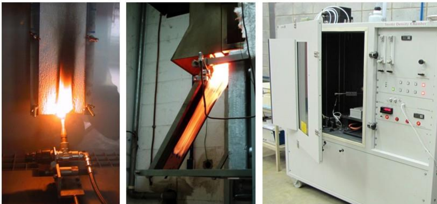
Figura 9 – Equipamentos para ensaios de ignitibilidade, propagação superficial de chamas e densidade óptica de fumaça (Fonte: IPT)
