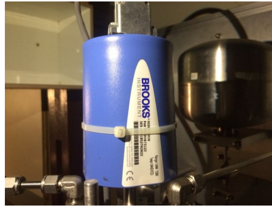
Medidor de pressão com membrana capacitiva
