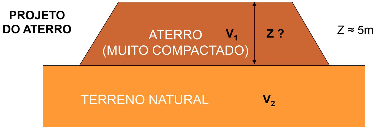
⇒ Possível inversão de velocidade,  $V_2 < V_1$  :
