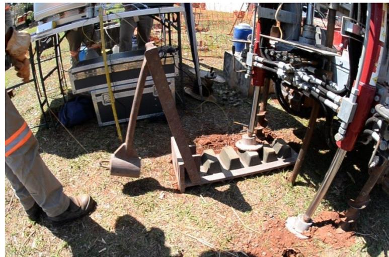
Dilatômetro de Marchetti Sismico (SDMT) - Damasco Penna
