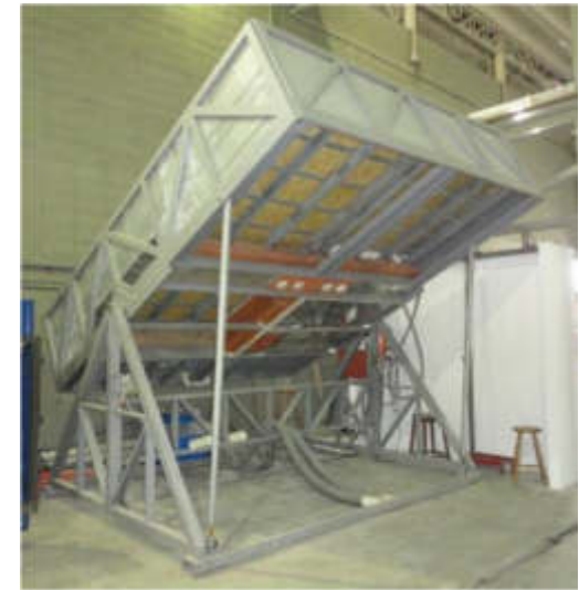
Estanqueidade à água de coberturas
