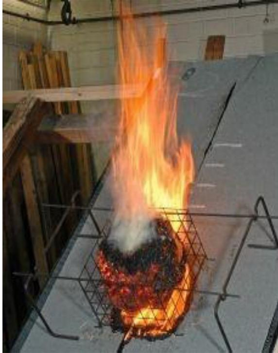
Avaliação de telhados e revestimentos de cobertura submetidos a uma fonte de ignição externa:  $(650 \pm 50)$ g de palha de madeira; cesto de arame 300 mm x 300 mm x 200 mm.
