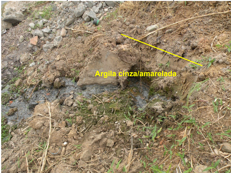
Figura 28 – Camada de argila cinza/amarelada na base do perfil. Gleissolo Háplico (Ponto CAp-05, Coord. UTM: 282.605/7.463.167).
