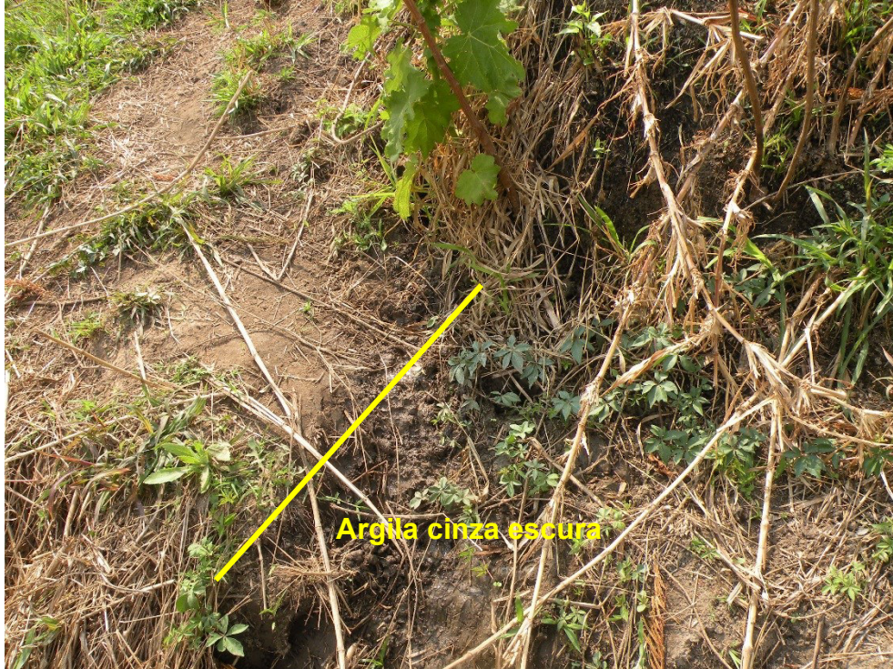
Figura 25 – Camada de argila cinza escura na base do perfil. Gleissolo Háplico. (Ponto CAp-02, Coord. UTM: 284.129/7.460.032)
