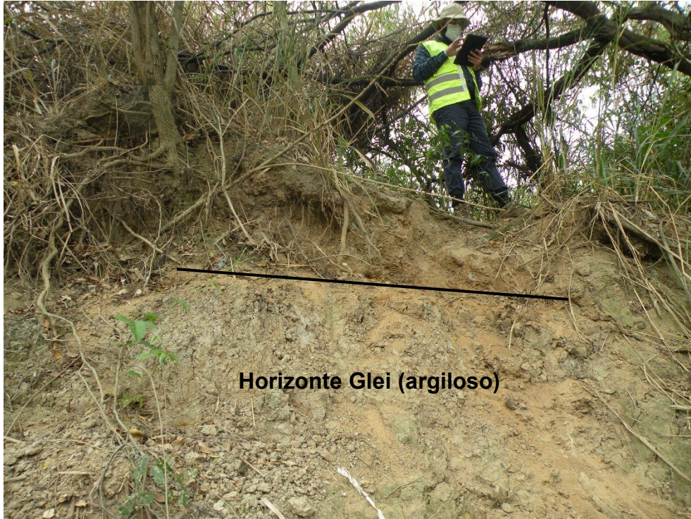
Figura 29 – Camada de argila pouco arenosa cinza/amarelada na base do perfil. Gleissolo Háplico. Horizonte glei (Cg). Margem direita do rio Capivari. (Ponto CAp-08, Coord. UTM: 278.554/7.4459.899).
