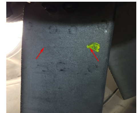
Duas pás trincadas no Jv2.
