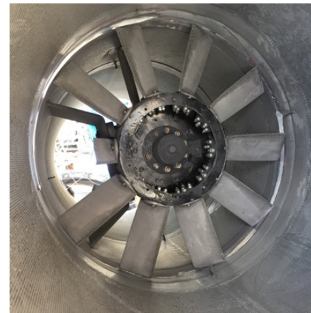
Fratura de uma das pás no JV17.
