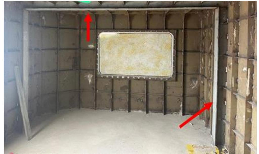
Reforço estrutural em instalação no refeitório do empurrador.
