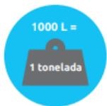
Se você colocar o reservatório sobre uma laje, telhado ou estrutura, verifique se esta é capaz de aguentar a carga extra. Cada litro d'água pesa cerca de 1 kg. Um reservatório de 1000 litros, quando cheio, pesará mais de uma tonelada!
