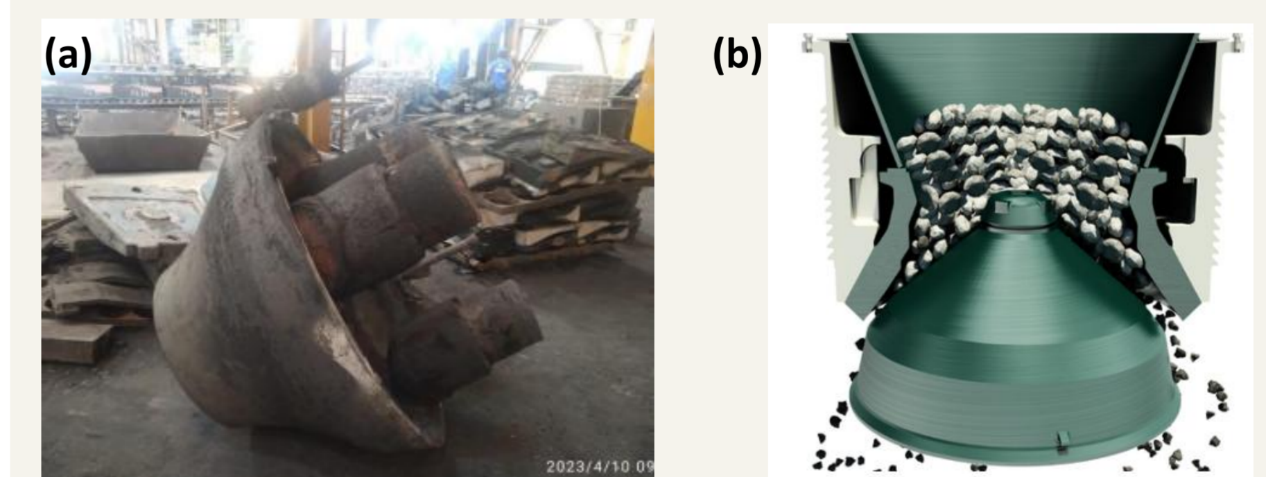
Figura 5. Peça fundida após desmoldagem (a) e exemplo de um britador cônico (b).
