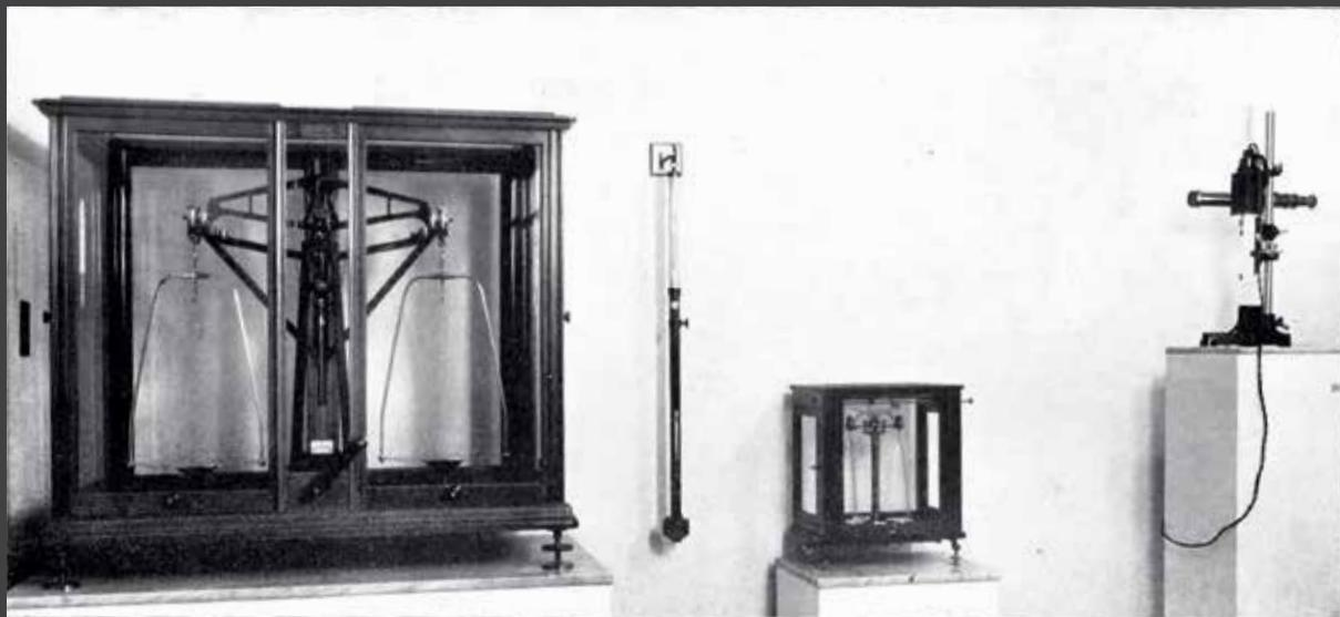
Figura 3.2.5. Imagem de comparador transversal do IPT, para medir até 1,30 m ao décimo de micron, estando instalado para a respectiva comparação, pertencente ao IPT e outro em latão, da seção retangular, pertencente a prefeitura de São Paulo<sup>(2, p.31)</sup>.
