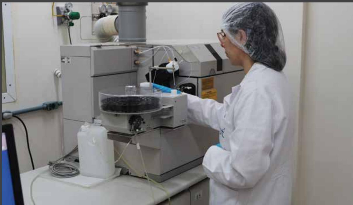
Figura 3.5.4. Imagem de espectrômetro de raios-X comprado com recursos da Finep em 2008 e usado para análise elemental e caracterização química de amostras (Acervo IPT).
