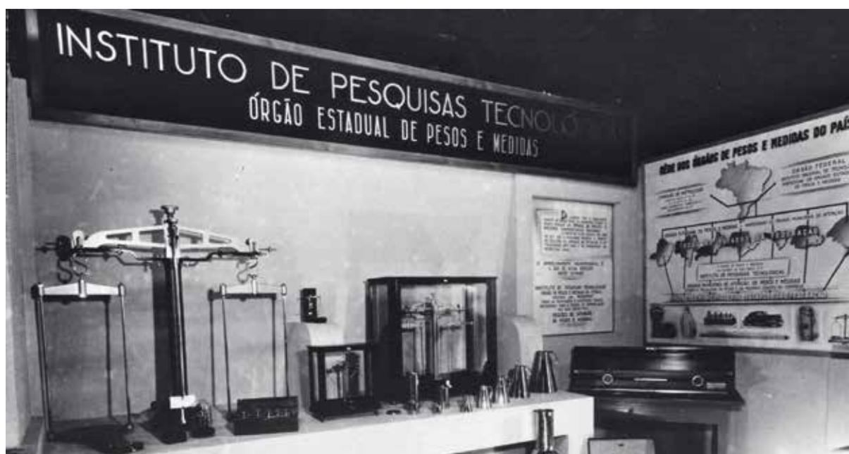
Figura 3.2.4. Vista parcial da sala de medidas de alta precisão do IPT . Da esquerda para a direita: Balança Ruetrecht para pesar até 5 kg, sensível ao décimo de mg; Barômetro, para a correção de pesagens; Balança range, para pesar até 200 gramas, sensível ao centésimo de mg; Posto de observação da balança Ruetrecht<sup>(2, p.16)</sup>.
