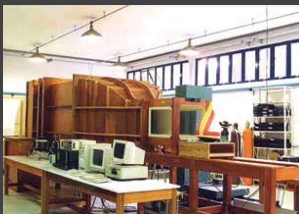
Figura 3.5.31. Imagem do Túnel de vento de camada limite atmosférica.
