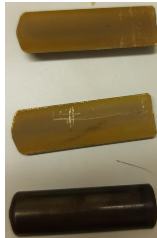
Pinos fundidos e seccionados para ensaios de flexão
