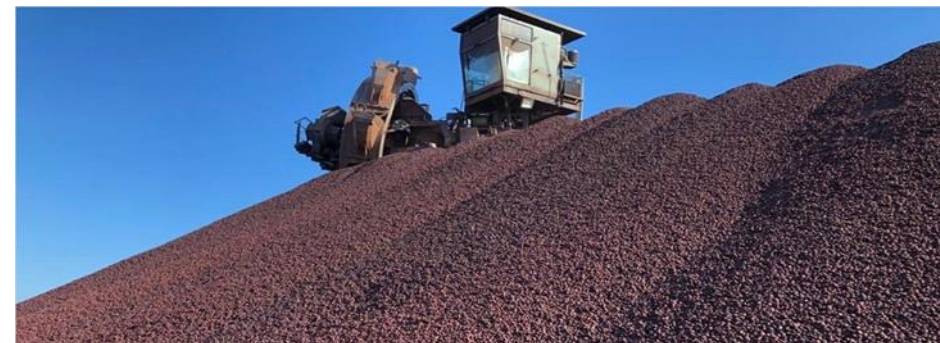
Exemplo de Pilha de briquetes. Briquetes serão produzido em plantas no Espírito Santo e em Minas, com capacidade total de 7 milhões de toneladas por ano.
