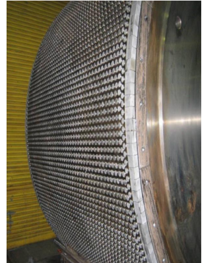
Superfície da prensa HPGR. Posicionamento dos pinos de WC-Co.
