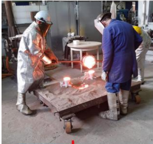
Vazamento das peças
