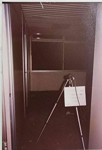
FOTO 4 - Instalação do sensor para medição da sobrepressão no ar, 3º andar do Edifício Segurasil.
