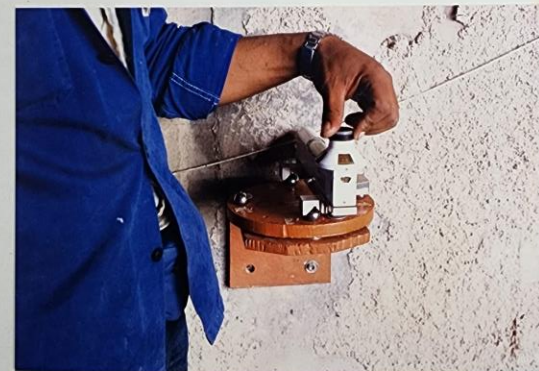
FOTO 8 - Detalhe de uma base para o clinômetro removível. Rotações em 2 planos verticais, perpendiculares entre si.
