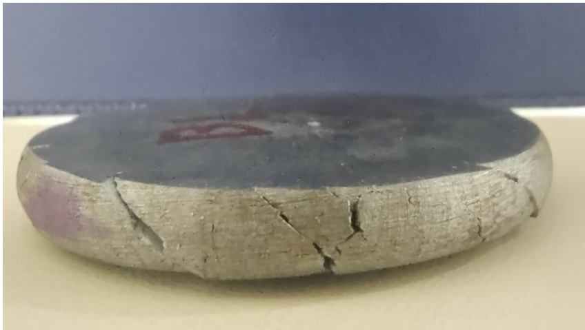
Amostra na condição microestrutural 1 após a etapa de conformação a frio
