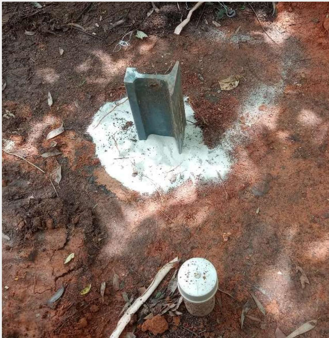
A) Trilho de aço enterrado 3 metros no solo; B) Gráfico mostrando a intensidade total do campo magnético medida no furo adjacente ao trilho; C) Gráfico do sinal analítico; D) O valor máximo do sinal analítico é observado na posição de 2,8 metros, próximo ao final da estaca.
