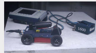
Figura 2: Equipamento de Radar (GPR) utilizado para a detecção de anomalias em estruturas de concreto.
