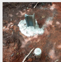
Figura 08 – Foto do Trilho Enterrado ao Lado do Furo
