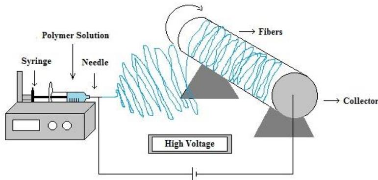
Ilustração esquemática do processo de eletrofiação
