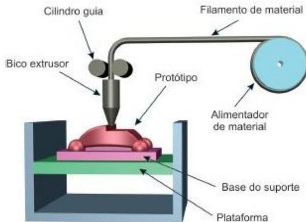
Ilustração esquemática do processo de impressão 3D
