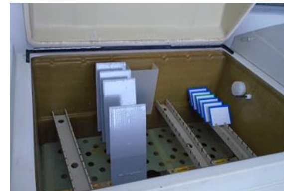
Corpos de prova durante os ensaios de degradação ambiental (envelhecimento) - Salt Spray
