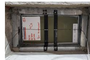
Posicionamento dos termopares no CP
