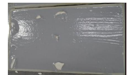
Face exposta ao fogo após envelhecimento
