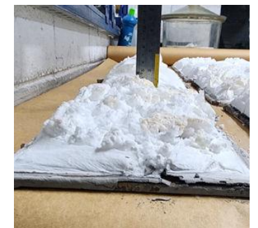
Detalhe da expansão do revestimento
