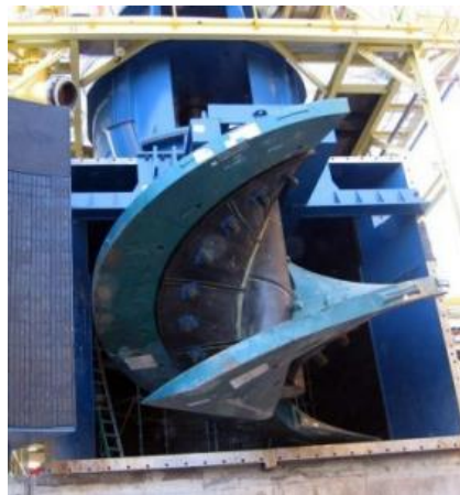
Revestimento de moinho
