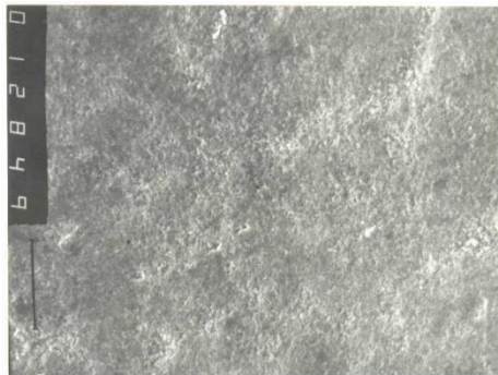
Fotomicrografia da superfície de um papel revestido com pigmento mineral
