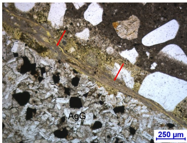
Figura 17 – As setas vermelhas indicam microfissuras na interface pasta-agregado preenchidas por gel de reação álcali-silica (RAS). Fotomicrografia de microscopia óptica de luz transmitida, com polarizadores cruzados. (Fotomicrografia do autor)
