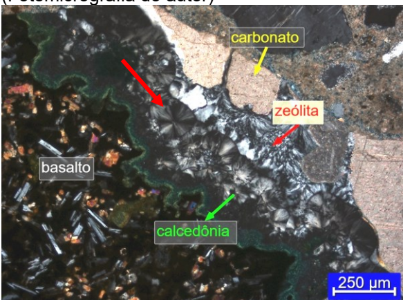
Figura 11 – As setas vermelhas e verdes indicam calcedônia e zeólita, dois minerais potencialmente reativos para RAS. Fotomicrografia de microscopia óptica de luz transmitida, com polarizadores cruzados. (Fotomicrografia do autor)
