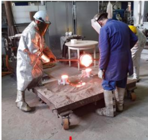
Vazamento das peças
