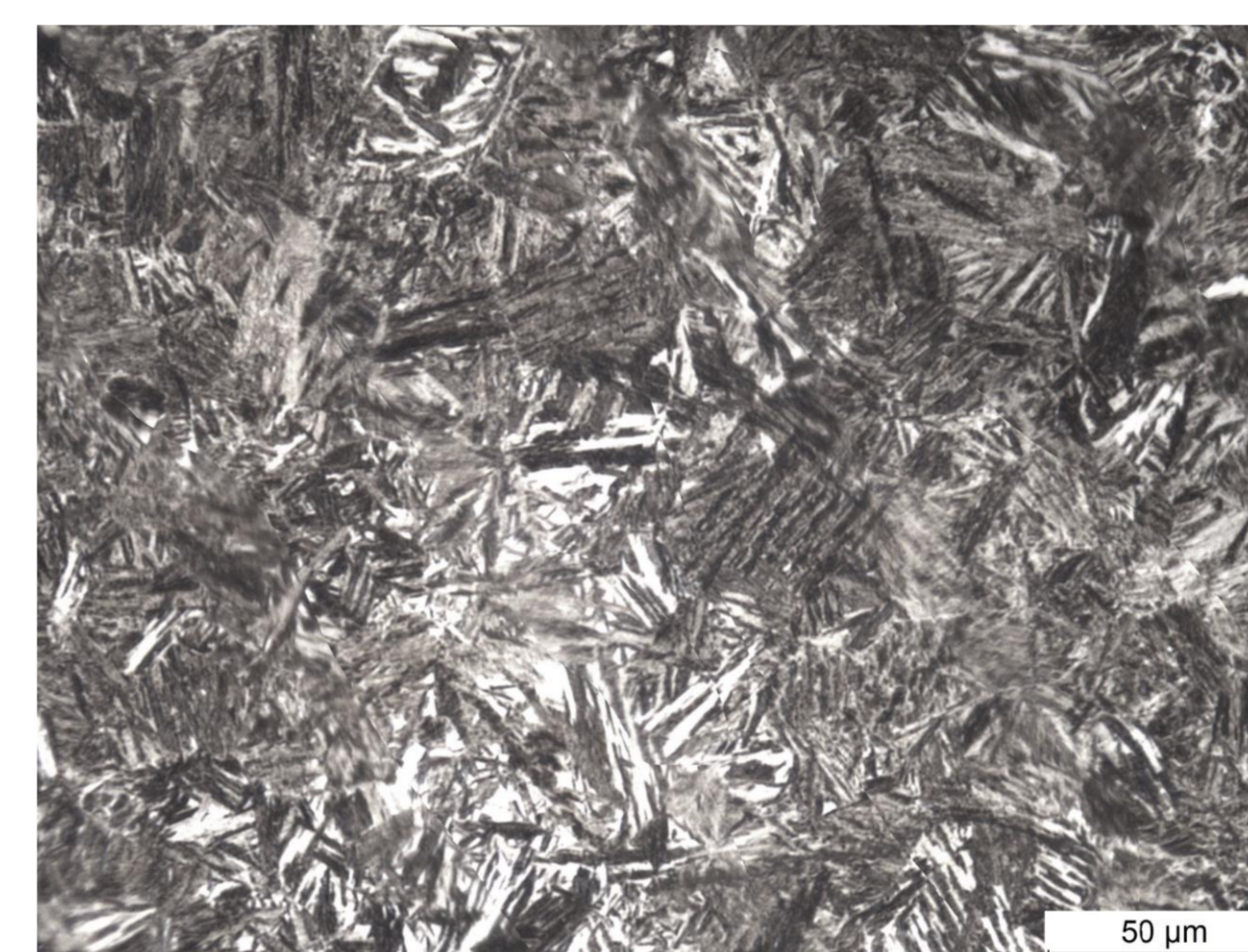
Figura 5: microestrutura de amostra austêmpera em 275°C. MO. Nital 2%.
