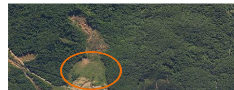
Figura 28 - Depósito de acumulação em sopé de encosta, com indicação de suscetibilidade a movimentos gravitacionais de massa - Ilhota, SC.
