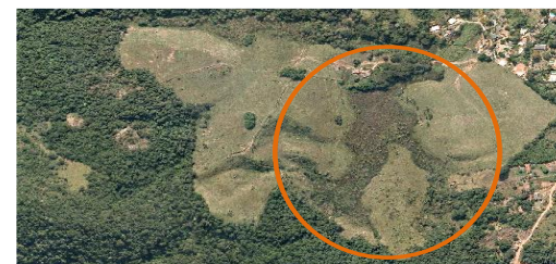
Figura 32 - Área úmida com tonalidade e texturas características e associação com presença de gramíneas típicas de áreas úmidas, indicativa de suscetibilidade a inundações e/ou alagamento.
