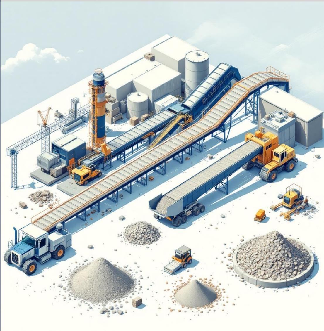
Em nossas usinas, os resíduos passam por processos de **triagem**, britagem e classificação, transformando-se em agregados prontos para uso.
