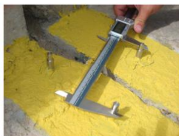
Paquímetro Aparelho para medida de aberturas de juntas.
