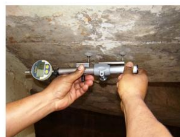
Relógio comparador Aparelho para medida de aberturas de fissuras e juntas.
