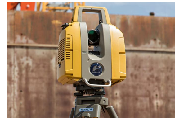
Uso de scanner para levantamentos de dados geométricos de OAE's
