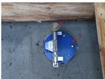
Clinômetro manual: Aparelho para medidas de rotações, in loco.
