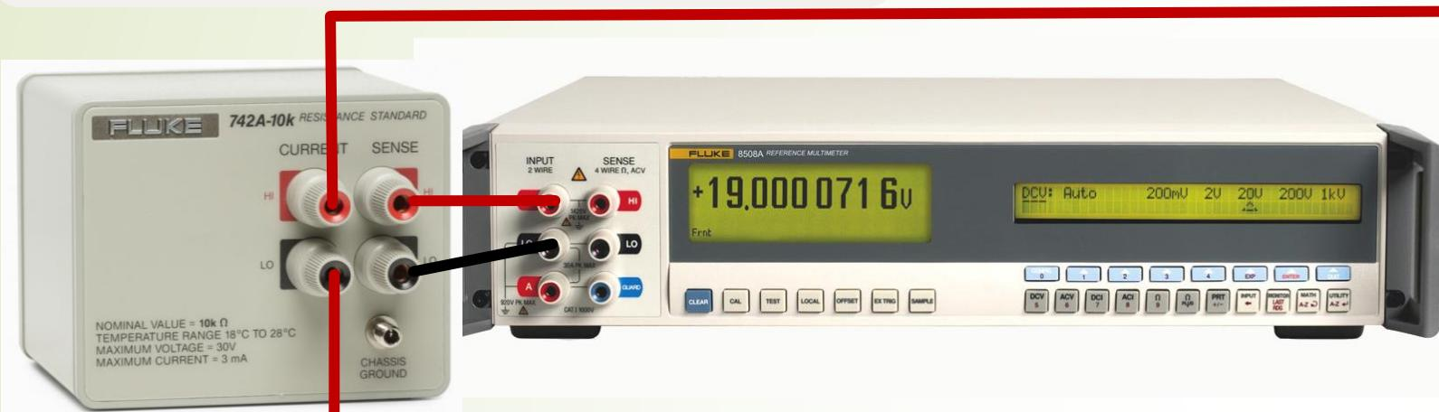
Multímetro padrão ( $V_{Rp}$ )
