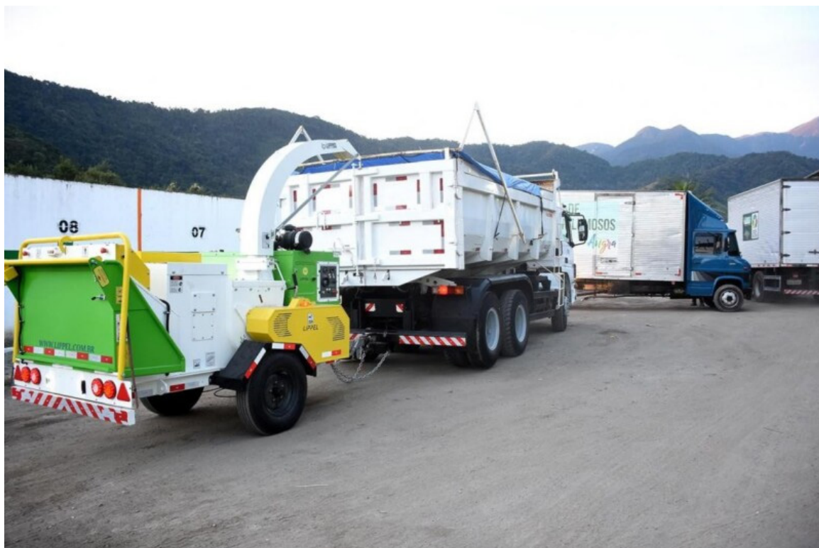
Figura 63 – Triturador de resíduos de poda acoplado ao caminhão de coleta
