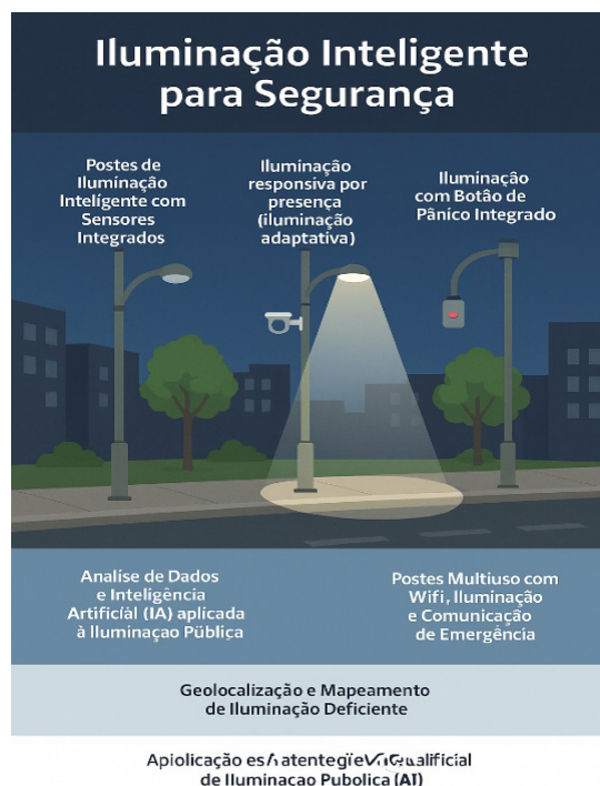
Figura 6.1 – Esquema visual dos sistemas digitais para iluminação em cidades inteligentes
