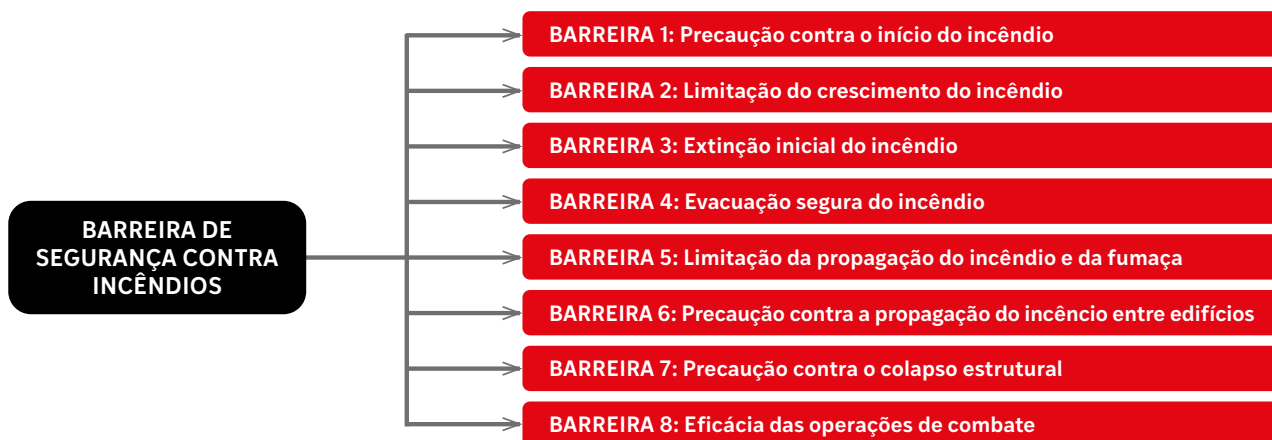
Figura 4.3 – Diagrama da lógica da segurança contra incêndio
